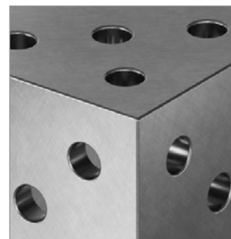
Материал – высококачественная сталь S355J2 Степень твердости в Вickers 450-550
