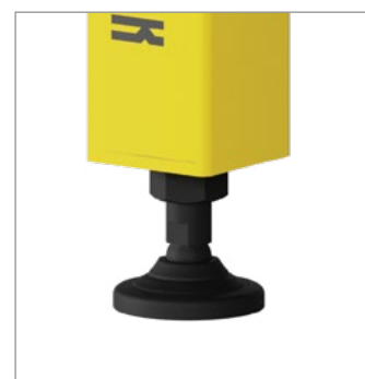
Опоры стола — труба 90x90 Опорная пятка — D 100 Высота регулировки — 50 мм
